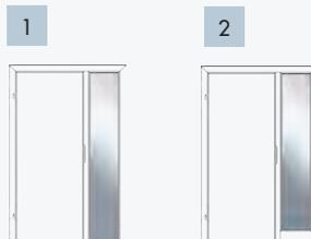
Seitenteil wahlweise mit Querholz unten oder Verglasung bis zum Boden:
