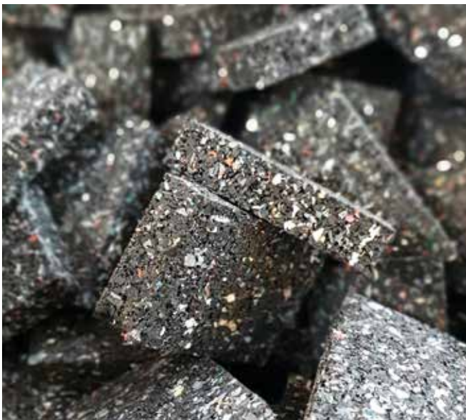
Isopads aus 95 % Altreifengranulat
