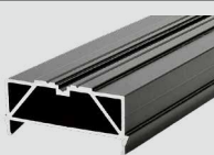
BIG-Isostep (Alu) 54 Terrassenlager Abstand Auflagepunkte max. 110 cm
